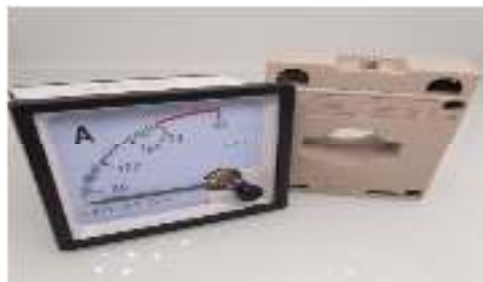
Gambar 2.12 ampermeter analog dan current transformator
