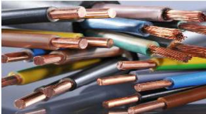
Gambar 2.18 Kabel solid dan Kabel stranded
