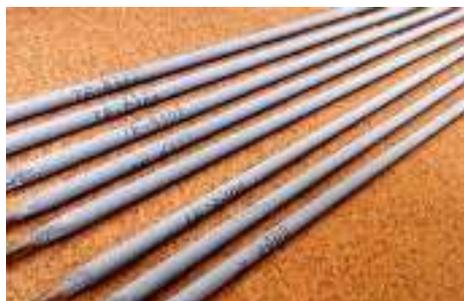
Gambar 3. 14 Elektroda Las
