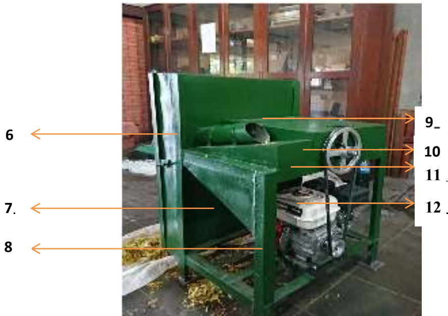
Gambar 3.2 mesin perajang daun tembakau bagian sisi belakang
