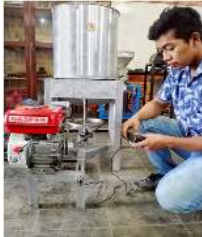
Gambar 3.6 Pengukuran getaran pada landasan tabung dengan arah vertikal, horizontal dan longitudinal.
