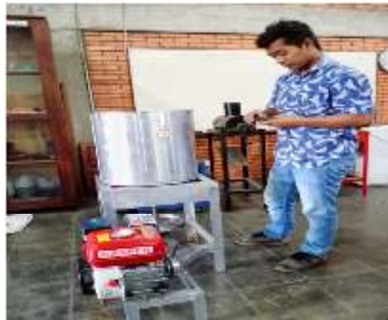
Gambar 3.6 Pengukuran getaran pada landasan tabung dengan arah vertikal, horizontal dan longitudinal.
