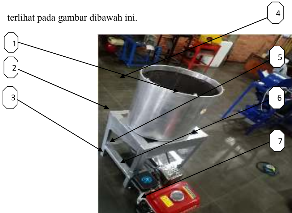
Gambar 3.1 Mesin pengupas kulit Kentang dan keterangannya
