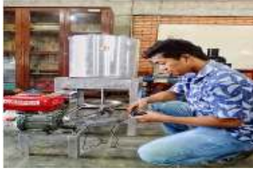
Gambar 3.7 Pengukuran getaran pada landasan mesin dengan arah vertikal, horizontal dan longitudinal.
