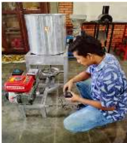
Gambar 3.6 Pengukuran getaran pada landasan tabung dengan arah vertikal, horizontal dan longitudinal.
