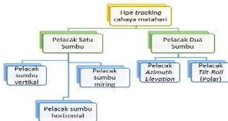
Gambar2.7 : Tipe solar tracking berdasarkan sumbu putaran
