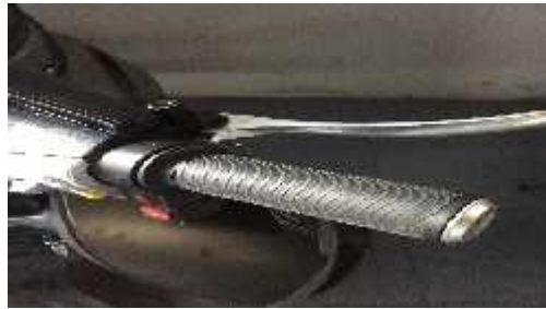
Gambar 2.6 Handle Gas dan Handle Brake
