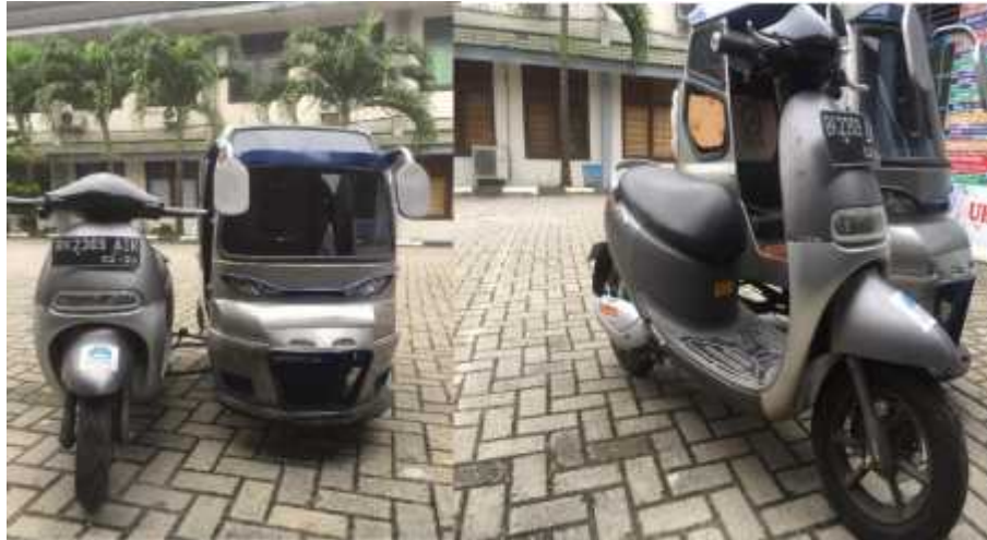
Gambar 2.5 Becak listrik tampak depan dan tampak samping
