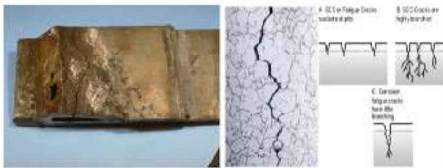
Gambar 2.8: Korosi Retak Tegangan
