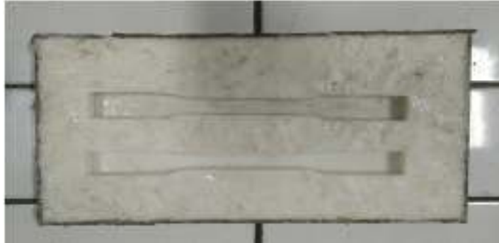
Gambar 3.7. Cetakan Karet Spesimen Uji Tarik ( Silica Rubber + Hardener )
