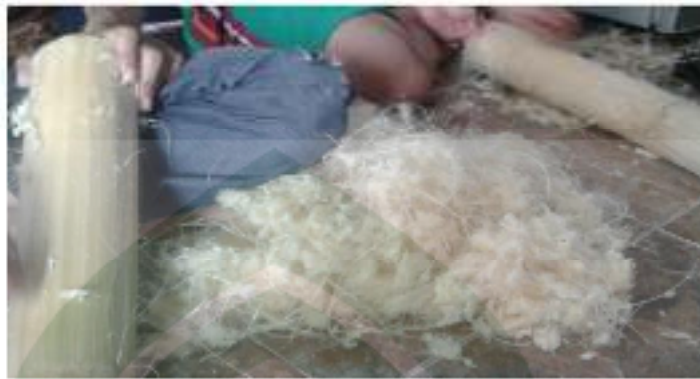
Gambar 3.2. Proses pengambilan serat bambu
