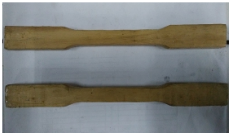
Gambar. 3.4. Pola spesimen uji tarik terbuat dari kayu.
