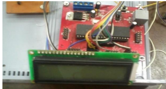
Gambar 4. Realisasi mikrokontroler ATmega8535 dengan rangkaian sensor dan LCD
