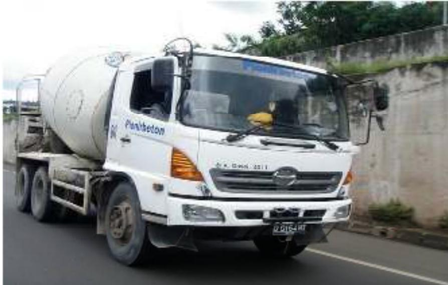
Gambar 2.9 Truk Beton Cor
