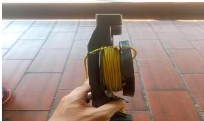
Gambar 3.3 Kabel Penghubung Elektroda Bantu 2
