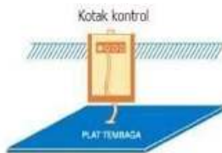
Gambar 2.10 Elektroda Pelat (a)
