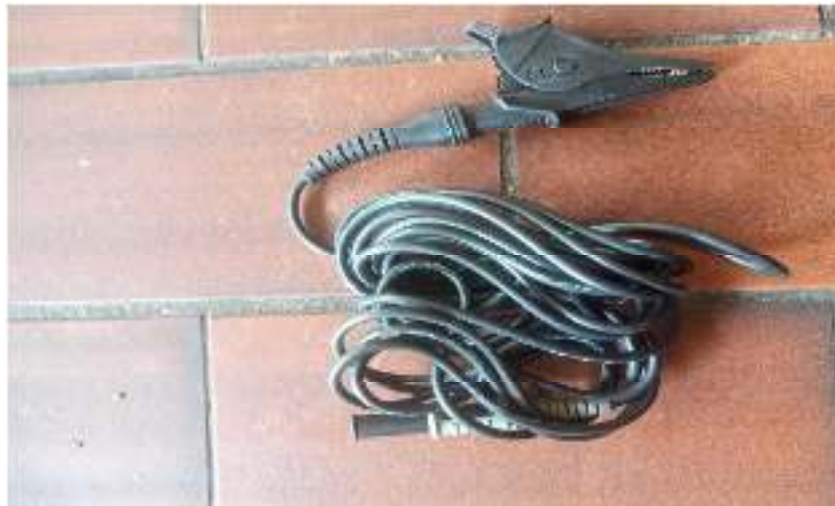
Gambar 3.1 Kabel Penghubung Elektroda Batang
