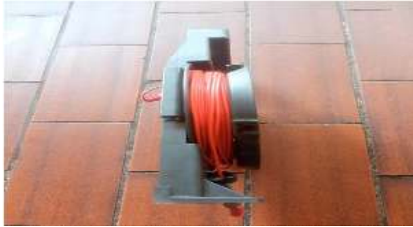
Gambar 3.2 Kabel Penghubung Elektroda Bantu 1
