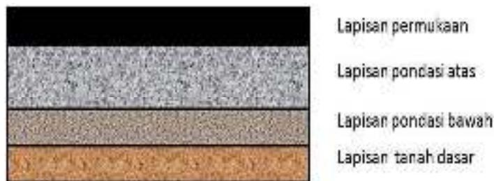
Gambar 2.1 Lapisan Perkerasan Lentur
