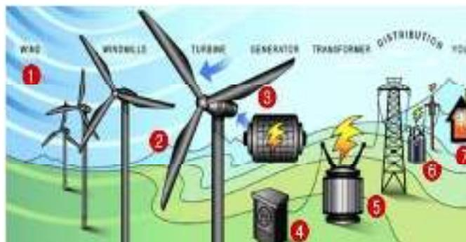
**Gambar 2.10 Prinsip Kerja Pembangkit Listrik Tenaga Angin**
