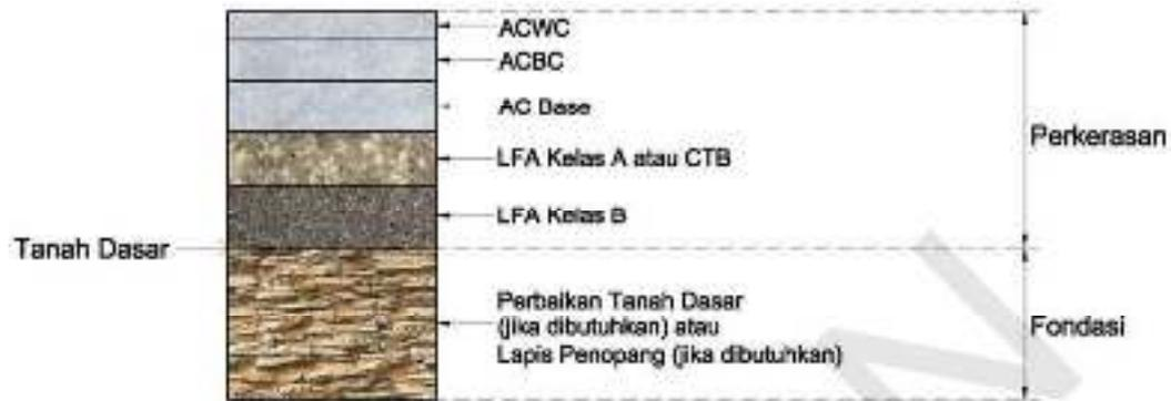
Gambar 2. 1 Konstruksi Perkerasan Lentur
