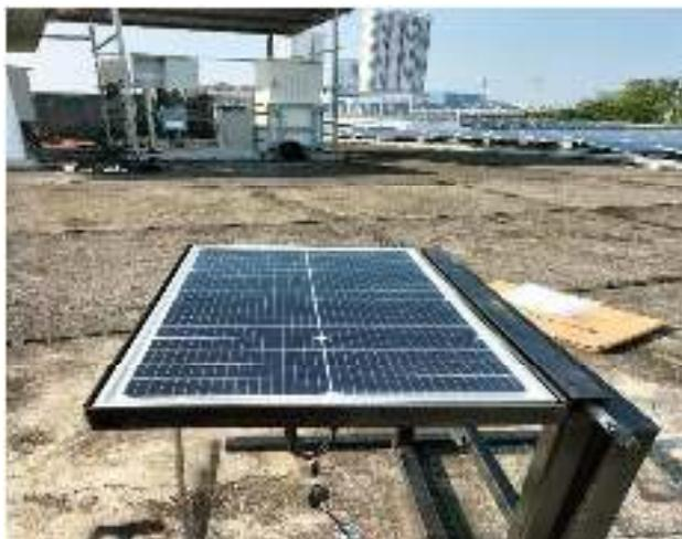
Gambar 3.7 Panel Surya Sudut Kemiringan  $0^\circ$
