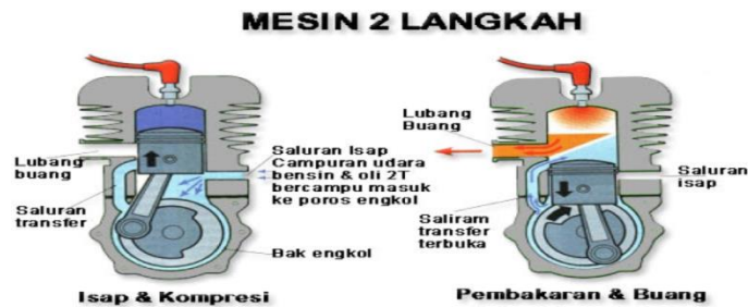
Gambar 2.1 Prinsip Kerja Mesin 2 Tak (Sumber: https://fastnlow.net )
