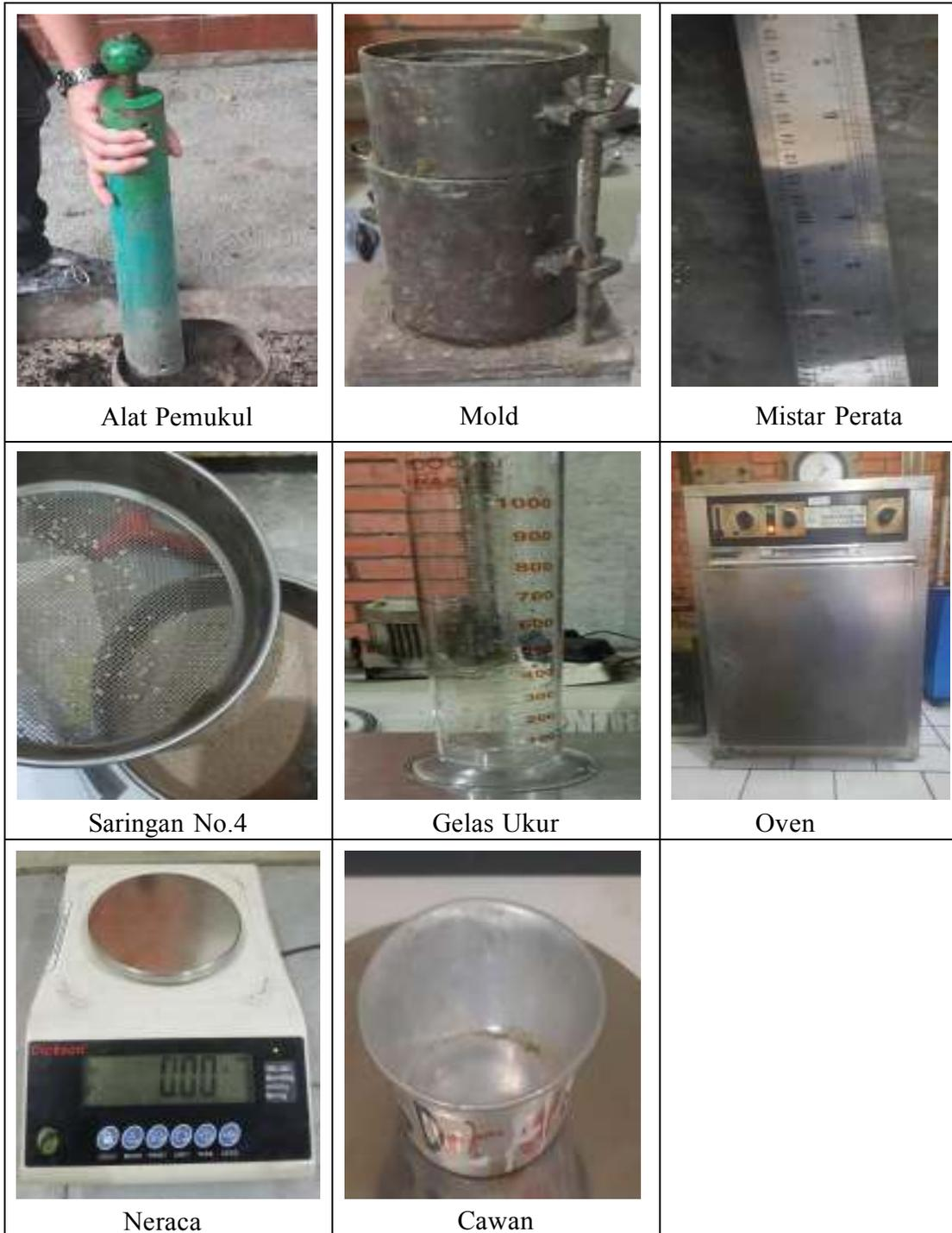
Gambar 3.10 Alat Pengujian Pematatan Tanah (*Proctor Modified*)
