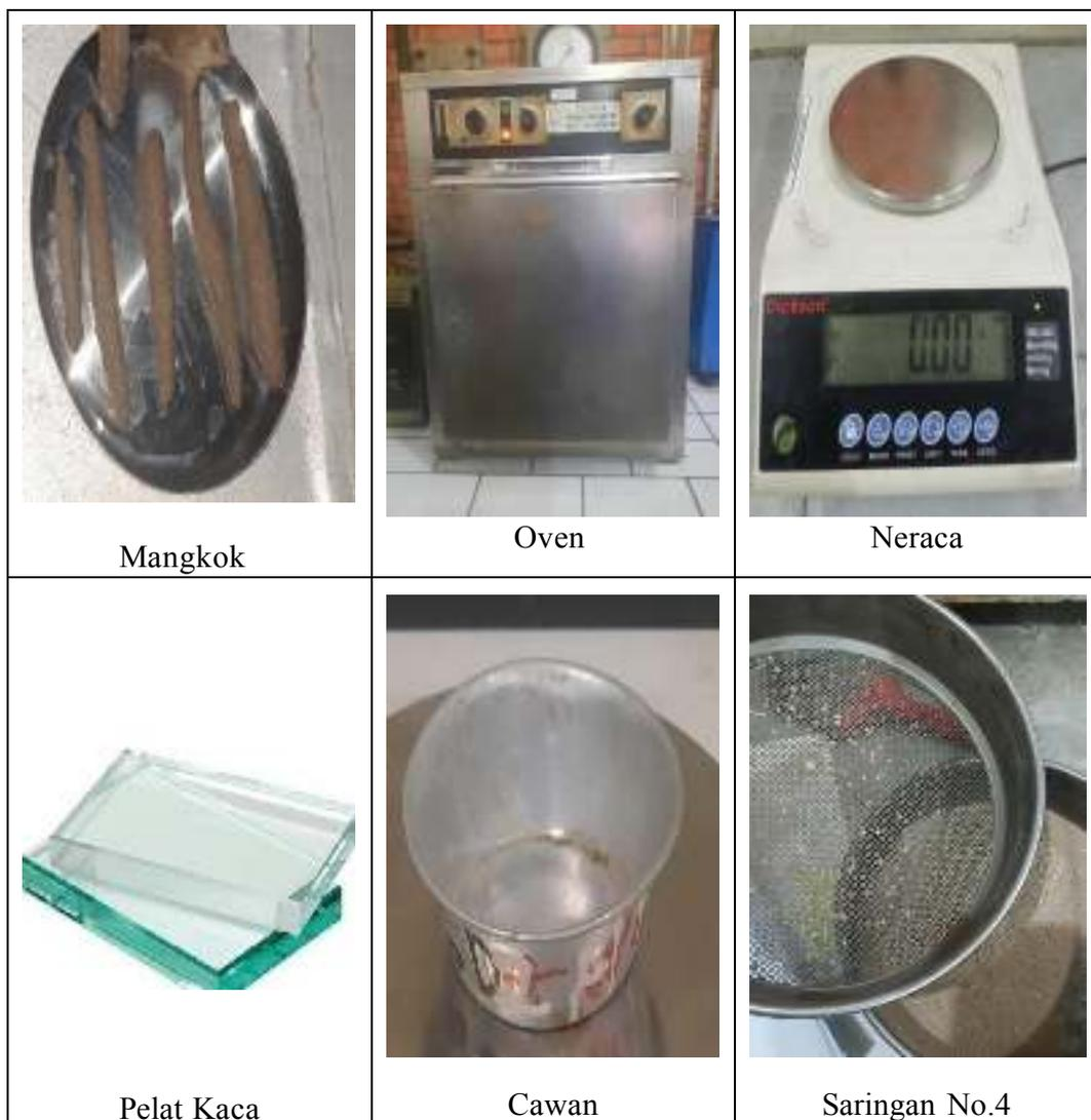
Gambar 3.9 Alat Pengujian *Plastis Limit* (Batas Plastis)
