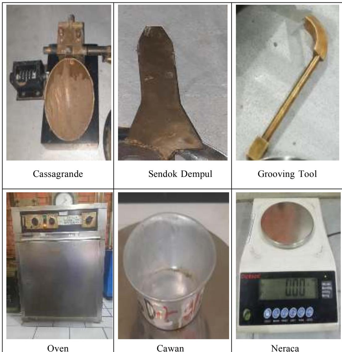
Gambar 3.8 Alat Pengujian Liquid Limit (Batas Cair)
