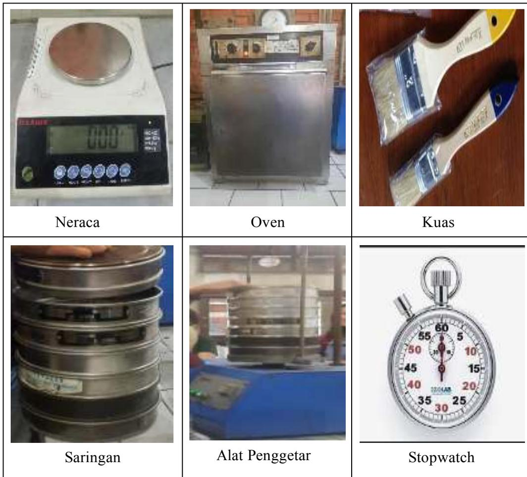
Gambar 3.6 Alat Percobaan Analisa Saringan
