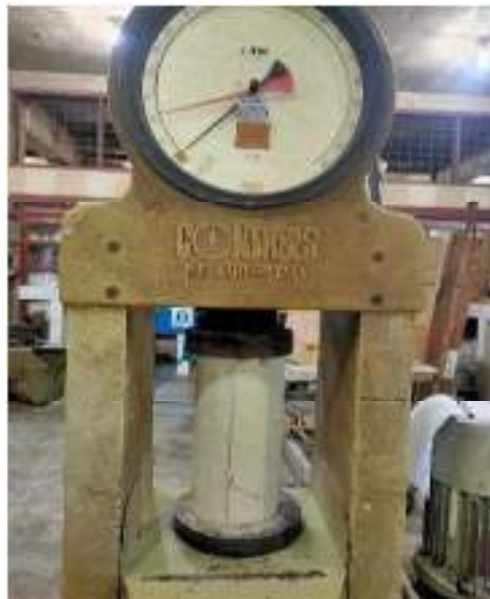
Gambar 2.5 Alat Kuat Tekan Contorls Milano-Italy (Sumber : Dokumen Pribadi, 2023)
