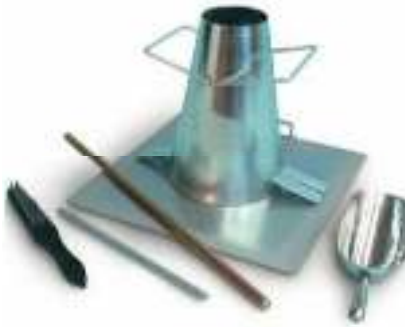
Gambar 2.4 Alat pengujian Slump Test (Sumber : SNI 1972 - 2008)
