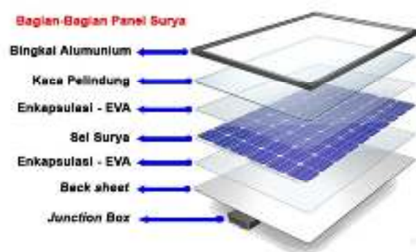
Gambar 2. 13 Konstruksi Panel Surya
