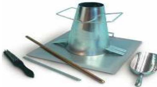
*Gambar 2. 1 Alat pengujian Slump Test*
