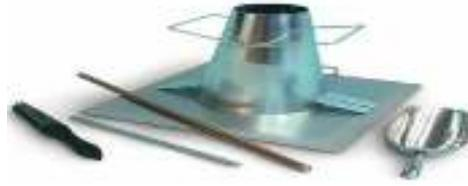
Gambar 2. 2 Alat pengujian *Slump Test*
