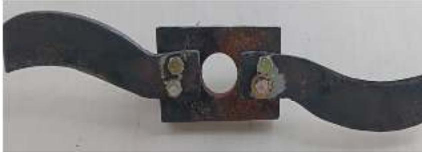
**Gambar 3.11 Desain pisau pencacah dengan ketebalan 2 mm**
