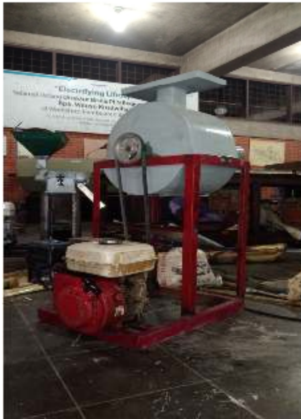
Gambar 3.5 Mesin Pencacah dan Pengaduk Pakan Ternak
