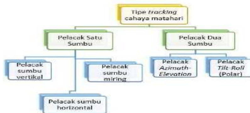
Gambar 2.7 :Tipe solar tracking berdasarkan sumbu putaran (Sumber INVOTEK)
