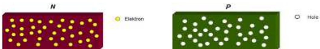
Gambar 2.4. Kondisi Semikonduktor Masih Terpisah
