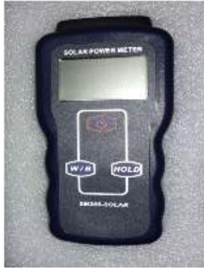
Gambar. 2.11. Solar Power Meter SM206-SOLAR
