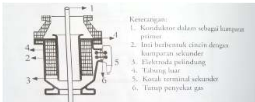
Gambar 2.10 Trafo Arus Inti Cincin Di Dalam Rel Daya Isolasi SF 6
