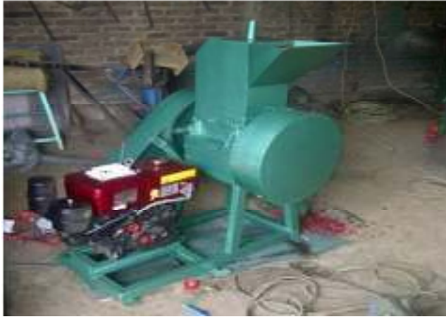
Gambar 2.4. Mesin Pencacah Plastik Kapasitas 50kg/jam
