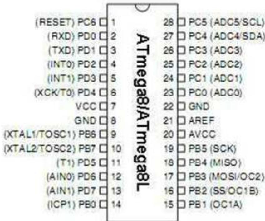
Gambar 2.6.1 Konfigurasi Pin Atmega8
