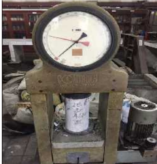
Gambar pelaksanaan uji kuat tekan beton
