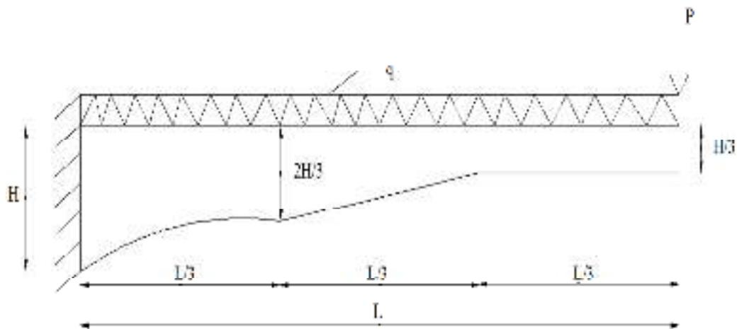
Gambar 3.2 Balok Kantilever Memikul Beban  $P$  dan  $q$
