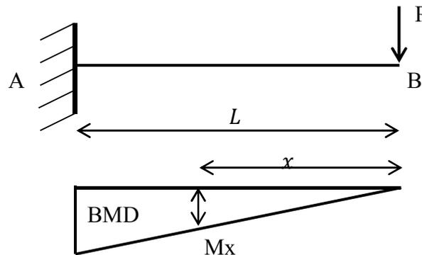
Gambar 2.1 Balok kantilever dengan beban titik
