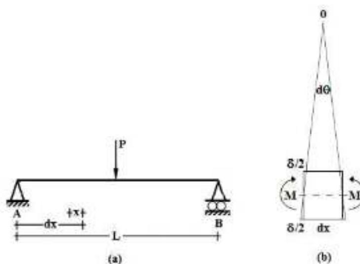
Gambar 2.15 Energi Regangan Pada Balok
