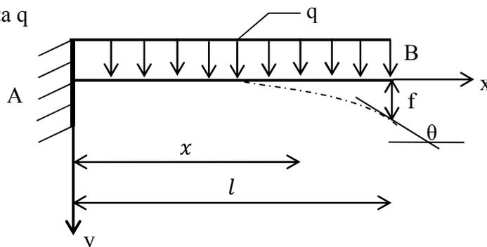
Gambar 2.2 Balok kantilever dengan beban terbagi rata  $q$
