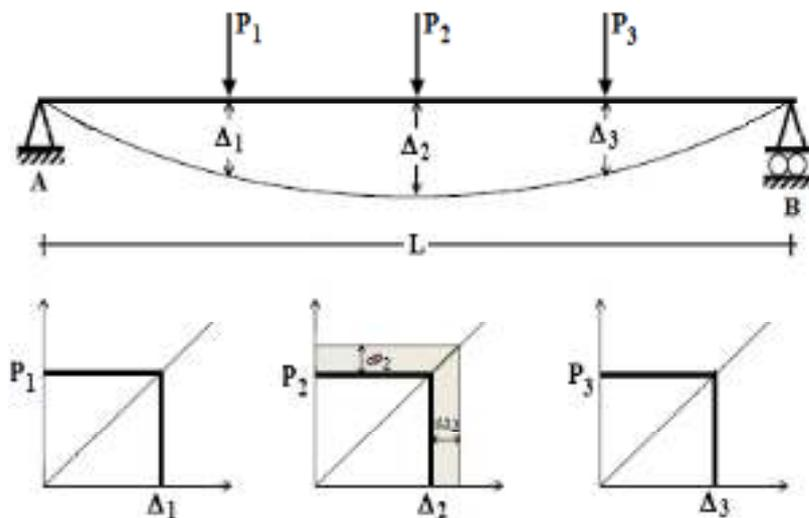
Gambar 2.16 Energi Regangan Pada Balok Sederhana
