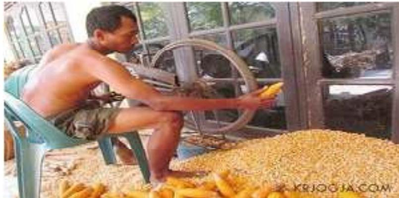
**Gambar 2. 5 Pemipil Jagung dengan Model Ban Sepeda**
