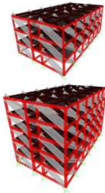
Gambar 2. 14 Model struktur 3 dan 5 lantai (Sumber : Sukrawa dkk, 2020)
